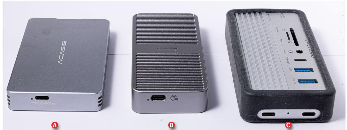
Abb. 2: Drei kleine Gehäuse für NVMe-SSDs, ca. 1,5 cm hoch/dick, ca. 6 cm breit und etwa 10 cm lang.
