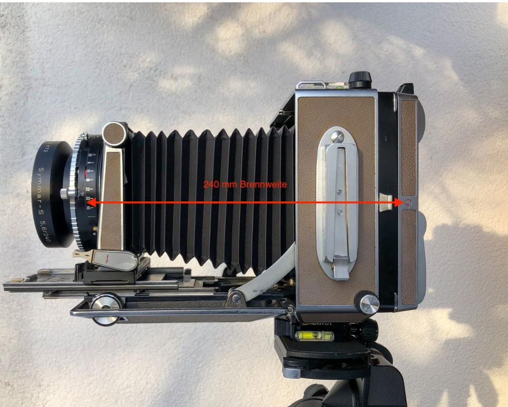
Abb. 3: Die Technika V mit dem montierten Symmar-S 240 mm/1:5,6 und dem auf die Objektivbrennweite ausgezogenen Balgen (der Abstand zwischen etwa der Mitte des Verschlusses und dem Filmebenensymbol auf dem Rückteil hinten beträgt 24 cm). Sie sehen deutlich den zweiteiligen Schlitten – der Oberschlitten wurde zunächst maximal ausgezogen (siehe Beschreibung unten), die letzten Zentimeter habe ich dann mit den Fokussierädern dazugegeben. Das Objektiv steht nun auf der Ausgangsposition »Unendlich«.
