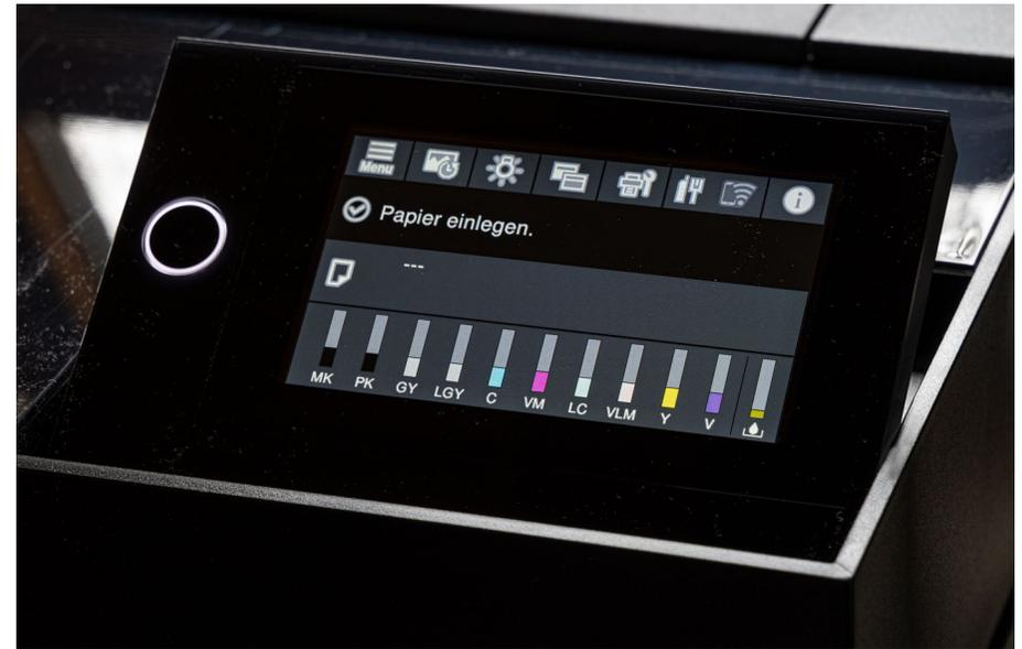
[2] Das neue klappbare Touch-Panel ist mit 15,5 × 11,5 cm deutlich größer geworden und gut ablesbar. Die Menüs sind gut gestaltet und Erläuterungen zu Menüpunkten farblich abgesetzt (s. Abb. 4).
