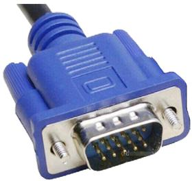
[7] VGA-Stecker – hier in der kompakteren VGA-D-Form. Ein VGA-Anschluss kann auch noch breiter sein und mehr Pins haben.
