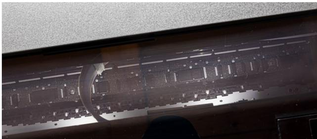
[7] Aktiviert man am Touchpanel das Lämpchen-Icon, so wird der Druckbereich per LEDs beleuchtet, und man sieht Teile des aktuellen Drucks (hier noch ohne Bild).
