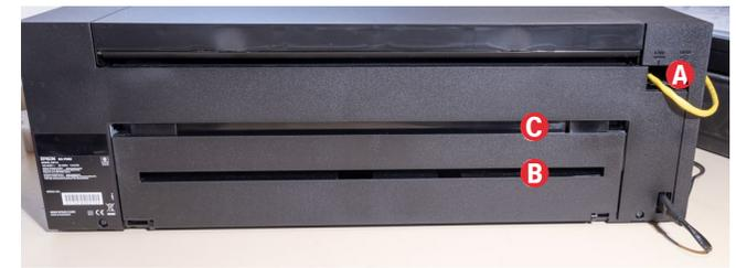
[6] Druckerrückseite, rechts Ⓐ die Klappe für das LAN- und das USB-Kabel, in der Mitte Ⓑ unten der Schlitz, aus dem Medien nach hinten herausragen, bevor und während sie bedruckt werden. Im oberen Schlitz Ⓒ wird Rollenpapier durch den Drucker geführt. Um den Rollenhalter zu montieren, muss man die Klappe hinten entfernen.
