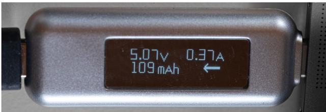
[6] Dieser kleine Zwischenstecker als »USB-C Power Meter« (für ca. 15 Euro) zeigt mir die Stromrichtung und -stärke sowie die anliegende Spannung an. Ich habe ihn hier zwischen den Rechner (rechts) und das Kabel zu einer SSD gesteckt.
