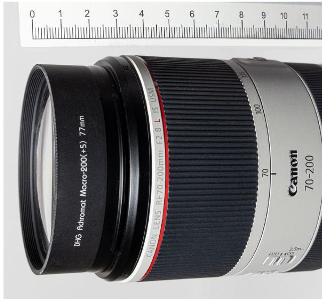
Abb. 4: Eine +5 dpt starke Nahlinse auf meinem 70–200-mm-Teleobjektiv mit einem Frontdurchmesser von 77 mm. Die Linse – ein Achromat – ist etwa 2 cm stark. Die Nahlinse mit +3 dpt hat faktisch die gleiche Stärke.
