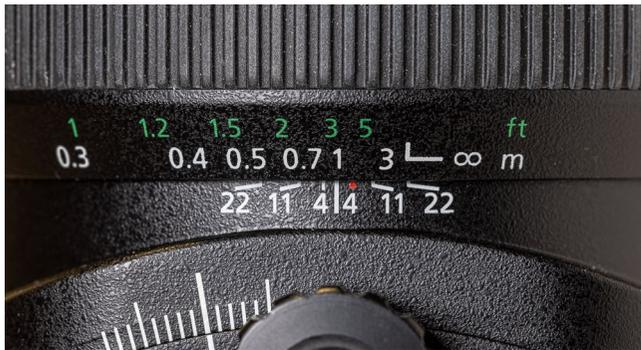
Abb. 2: Dieses noch aktuelle Tilt/Shift-Objektiv von Canon hat eine Skala, auf der man in der unteren Reihe die Schärfentiefe bei einer gewählten Blende und der aktuellen Entfernungseinstellung ablesen kann (bezogen auf Vollformat). Die Blende selbst wird aber auch hier bereits elektronisch über die Kamera eingestellt und ihr nomineller Wert dort angezeigt.
