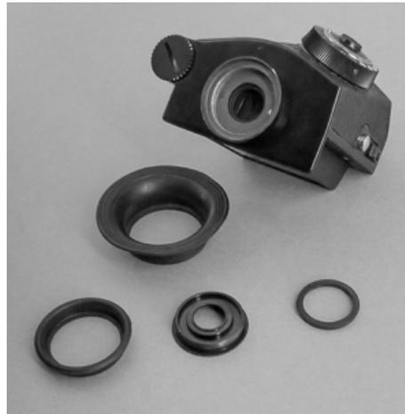
Abb. 3: Prismensucher mit Belichtungsmesser der »neuesten« Generation. Auf der Oberseite befindet sich nur noch das Rändelrad zum Ablesen der Werte. Für einen Dioptrienausgleich kann ins Sucherokular eine Korrekturlinse eingelegt werden. Rechts am Gehäuse ist der rechteckige Einschalter erkennbar.
