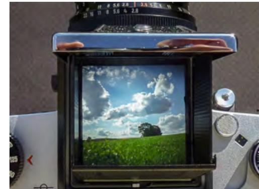
Abb. 5: Der Lichtschachtsucher zeigt 90 % des Bildfelds. Die Sicht wird seitenverkehrt angezeigt und das Motiv damit einzufangen erfordert einige Übung, weil es gerne an der unerwarteten Seite verschwindet.
