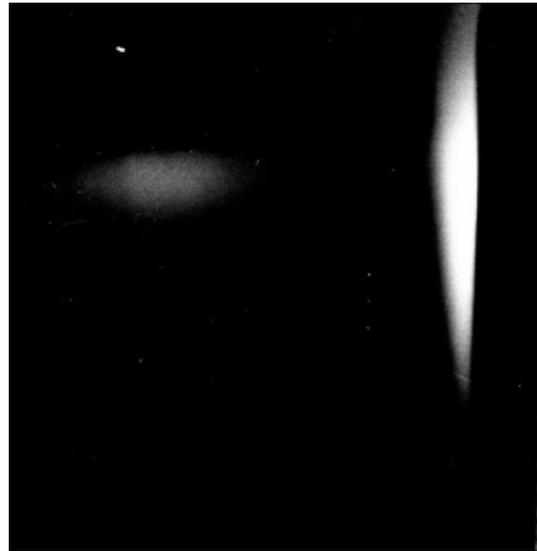
Abb. 2: Um solche Bilder zu vermeiden, sollten Objektive an der Kiev nur gewechselt werden, wenn der Verschluss nicht gespannt ist, was daran zu erkennen ist, dass Sucher oder Lichtschacht dunkel bleiben, weil der Spiegel nach dem Auslösen hochgeklappt bleibt. Mit einer kurzen Notiz zu jedem gemachten Bild lassen sich Fehlerursachen später besser eingrenzen.
