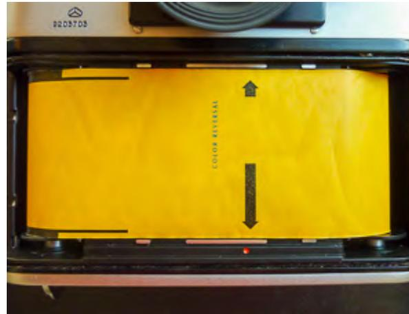
Abb. 7: Nach dem Einfädeln des Deckpapiers in die Aufwickelspule und mehrmaligem Betätigen von Transporthebel und Auslöser soll der Pfeil dem roten Punkt am Kameragehäuse gegenüber stehen. Dann kann die Rückwand geschlossen werden. Nach vier weiteren Hebelschwüngen zeigt das Bildzählfenster auf der Oberseite eine 1 – die Kamera ist bereit fürs erste Bild.
