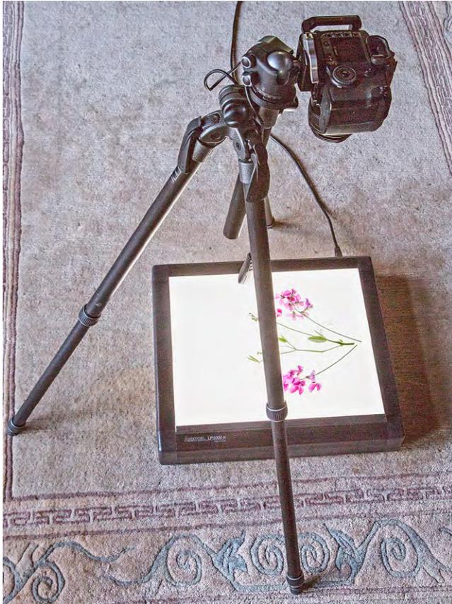
Abb. 2: Die Kamera auf Stativ nach unten geneigt steht über dem Leuchtpult und wird über Kabelauslöser ausgelöst.
