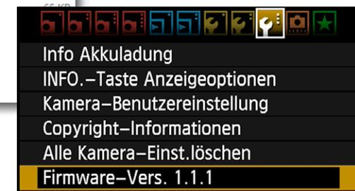
Abb. 3: Im Einstellungsmenü 3 (gelb) finden Sie die Option für das Update der Firmware, dort wird auch Magic-Lantern installiert. Bei der EOS 60D müssen Sie vorher z. B. die Firmware 1.1.1 installiert haben.
