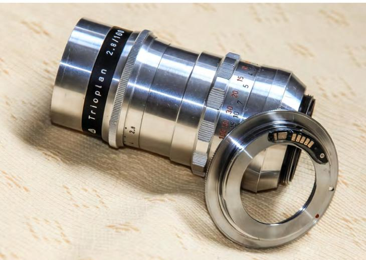
Das Trioplan, ein ›altes‹ F2,8/100-mm-Objektiv der Firma Meyer Görlitz mit dem M42-Adapter
