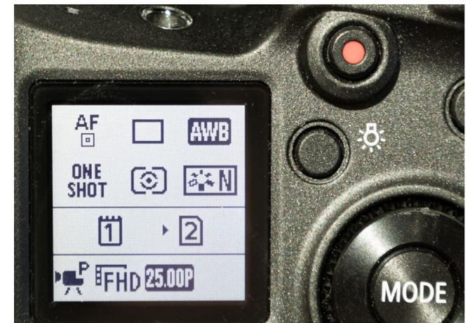
Abb. 3: Das Schulter-Display der R5 ist auch bei wenig Licht sehr gut lesbar, das Beleuchtungs-LED über den Knopf rechts davon hilft im Dunkeln aber kaum weiter.
