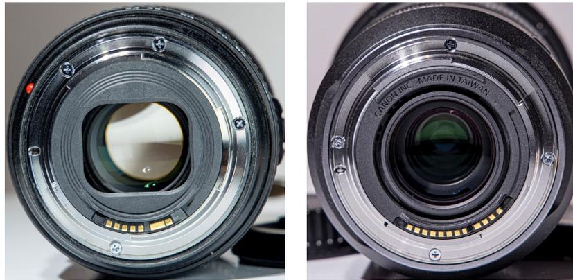
Abb. 1: Links das EF-Bajonett mit einem Auflagemaß von 44 mm und acht elektronischen Kontakten, rechts das RF-Bajonett mit zwölf Kontakten und einem Auflagemaß von 20 mm. Beide haben einen Bajonett Durchmesser von 54 mm.
