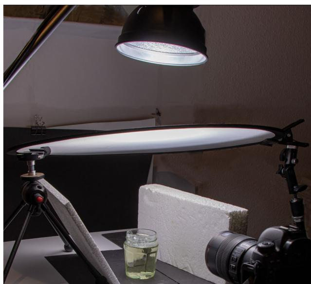
Abb. 3: Unser Aufbau: die Kamera mit Kabelauslöser auf einem Stativ; davor das Glas mit der Seifenlösung, im Hintergrund und unter dem Glas schwarzer Karton. Oben sieht man den weißen Diffusor und darüber die relativ starke LED-Leuchte.
