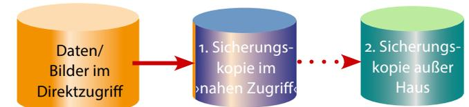
Abb. 1: Von den Daten sollte es nach dem 3-2-1-Konzept drei Kopien geben – eine davon offline außer Haus. Ich empfehle auch, die erste Sicherungskopie nach dem Sichern offline zu schalten, da so Viren und Erpressungs- bzw. Chiffrierungstrojaner nicht darauf zugreifen können.
