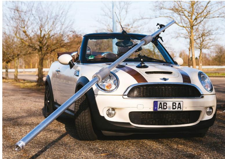
Abb. 3: Für die Montage der Sauger muss man plane Bereiche suchen. In den Fotos erkennen Sie auch, dass wir das Rohr mit Schaumstoffstücken ummantelt haben, um den Schaden an Lack und Glas klein zu halten, falls sich ein Saugnapf löst.
