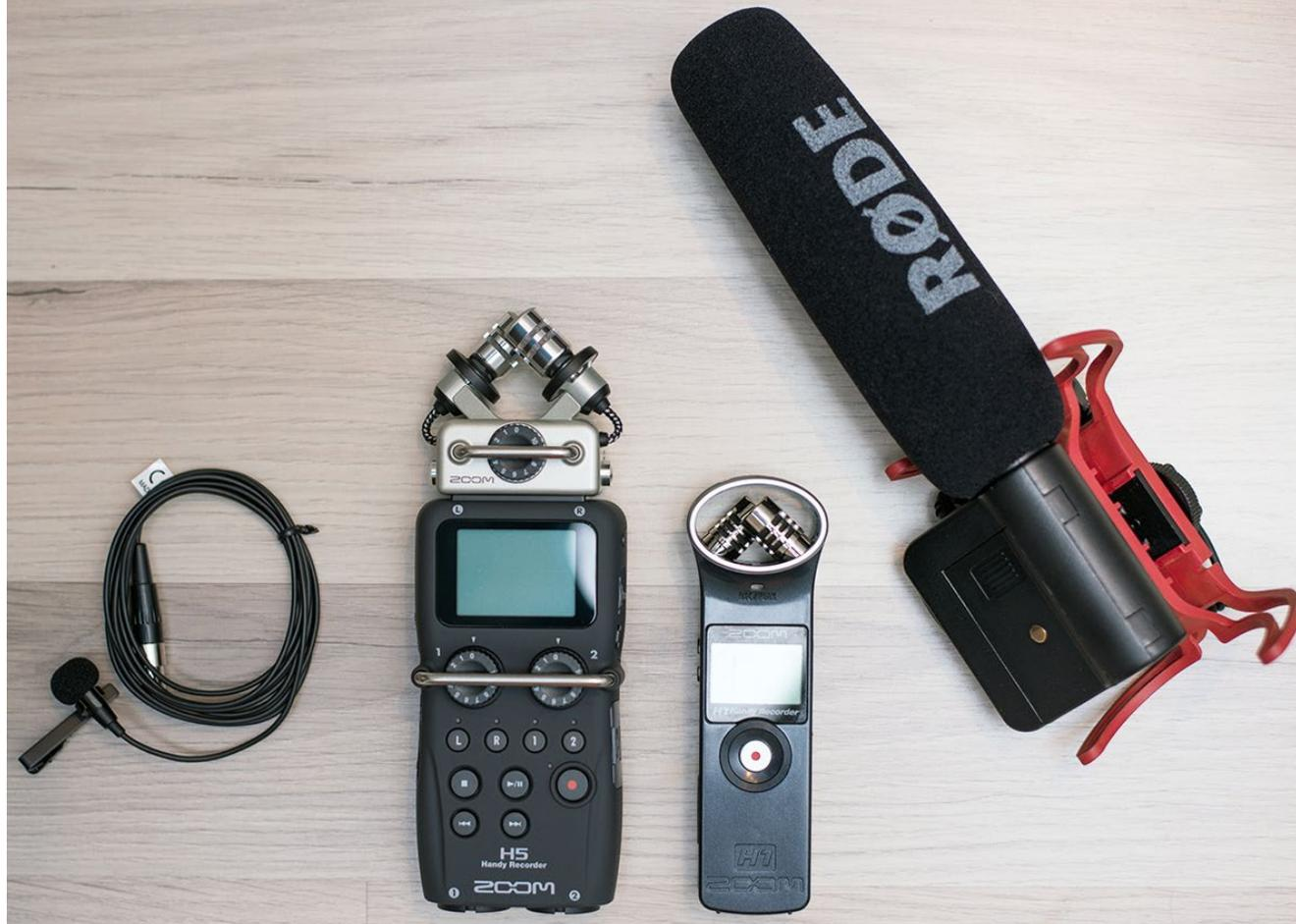
Abb. 3: Links ein Lavaliermikrofon (Ansteckmikrofon), in der Mitte zwei Audiorecorder und rechts ein Richtmikrofon
