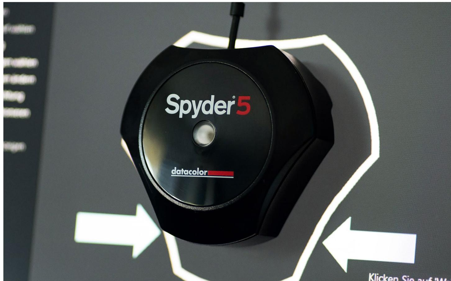
Abb. 3: Nachdem man den Deckel des Geräts entfernt hat, lässt sich der Spyders5 am Monitor positionieren.
