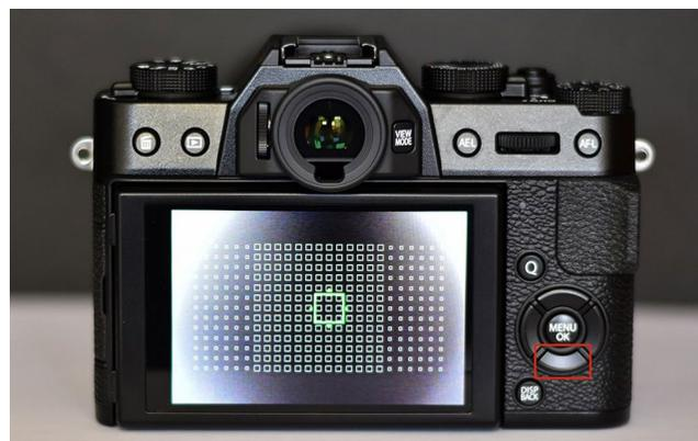
Abb. 8: Die AF-Felder lassen sich erst nach einmaligem Drücken der Nach-unten-Taste auswählen.
