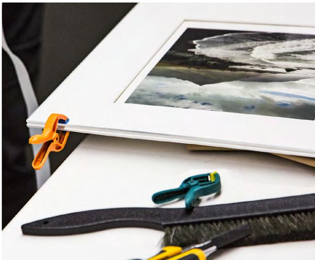
Abb. 5: Ein Abbürsten vermeidet eingeschlossene unerwünschte Partikel, kleine Klammern erleichtern die Montage.
