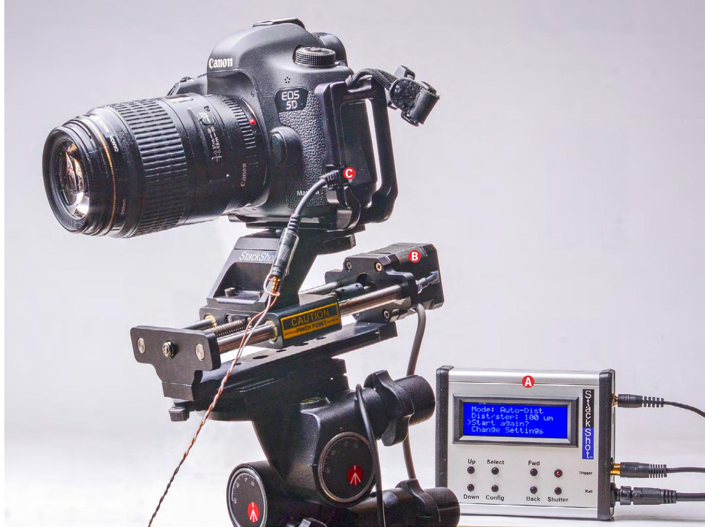
Abb. 1: Die Cognisys StackShot Steuerbox (A) rechts) steuert den Stepper-Motor (B) der Makroschiene und bewegt damit die Kamera. Der StackShot löst auch die Kamera aus – (C) hier mit gebasteltem Anschluss zwischen Kabelauslöser und StackShot-Anschluss.
