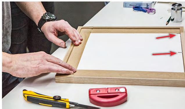
Abb. 6: Zum Schluss wird das Bild (bzw. der Rückenkarton) noch mit einem gummierten Klebeband mit dem Rahmen verklebt und damit praktisch versiegelt. Man sieht hier noch zwei der in den Rahmen eingeschossenen Metallstifte, welche die Kombination aus Glas, Passepartout, Bild und Rückenkarton im Rahmen halten.
