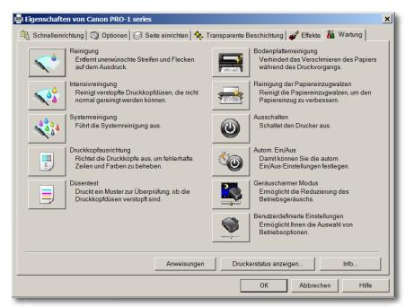
Abb. 4: Das Spektrum an Wartungsfunktionen im Treiber ist umfangreich (hier unter Windows 7).
