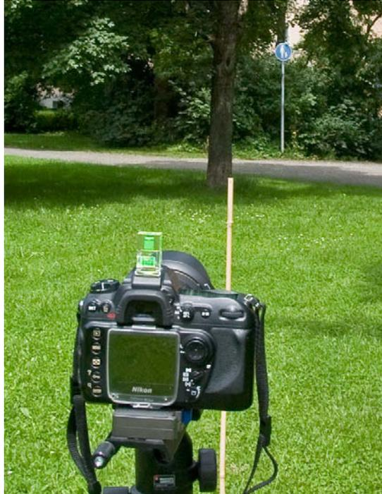
Abb. 3: Bringen Sie zwei Objekte mit geraden Kanten und deutlich unterschiedlichem Abstand zur Kamera (hier der Stock vorne und das Schild weiter hinten) in der Kamera etwa in der Bildmitte zur Deckung.
