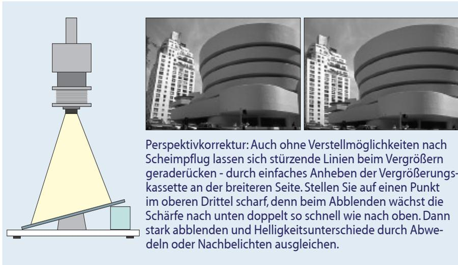
Perspektivkorrektur: Auch ohne Verstellmöglichkeiten nach Scheimpflug lassen sich stürzende Linien beim Vergrößern geraderücken - durch einfaches Anheben der Vergrößerungskassette an der breiteren Seite. Stellen Sie auf einen Punkt im oberen Drittel scharf, denn beim Abblenden wächst die Schärfe nach unten doppelt so schnell wie nach oben. Dann stark abblenden und Helligkeitsunterschiede durch Abwedeln oder Nachbelichten ausgleichen.
