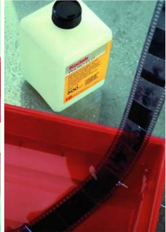
Ziehen Sie den Film jetzt langsam durch eine Schale mit Netzmittelbad.
