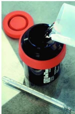
Nachdem der Entwickler eingefüllt ist, wird die Dose einmal aufgeklopft.
