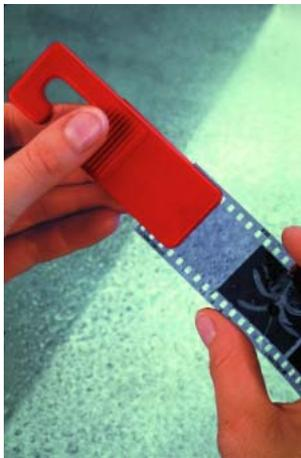
Zwei Klammern halten den Film beim Trocknen. Die untere Klammer soll den Film glatt ziehen.
