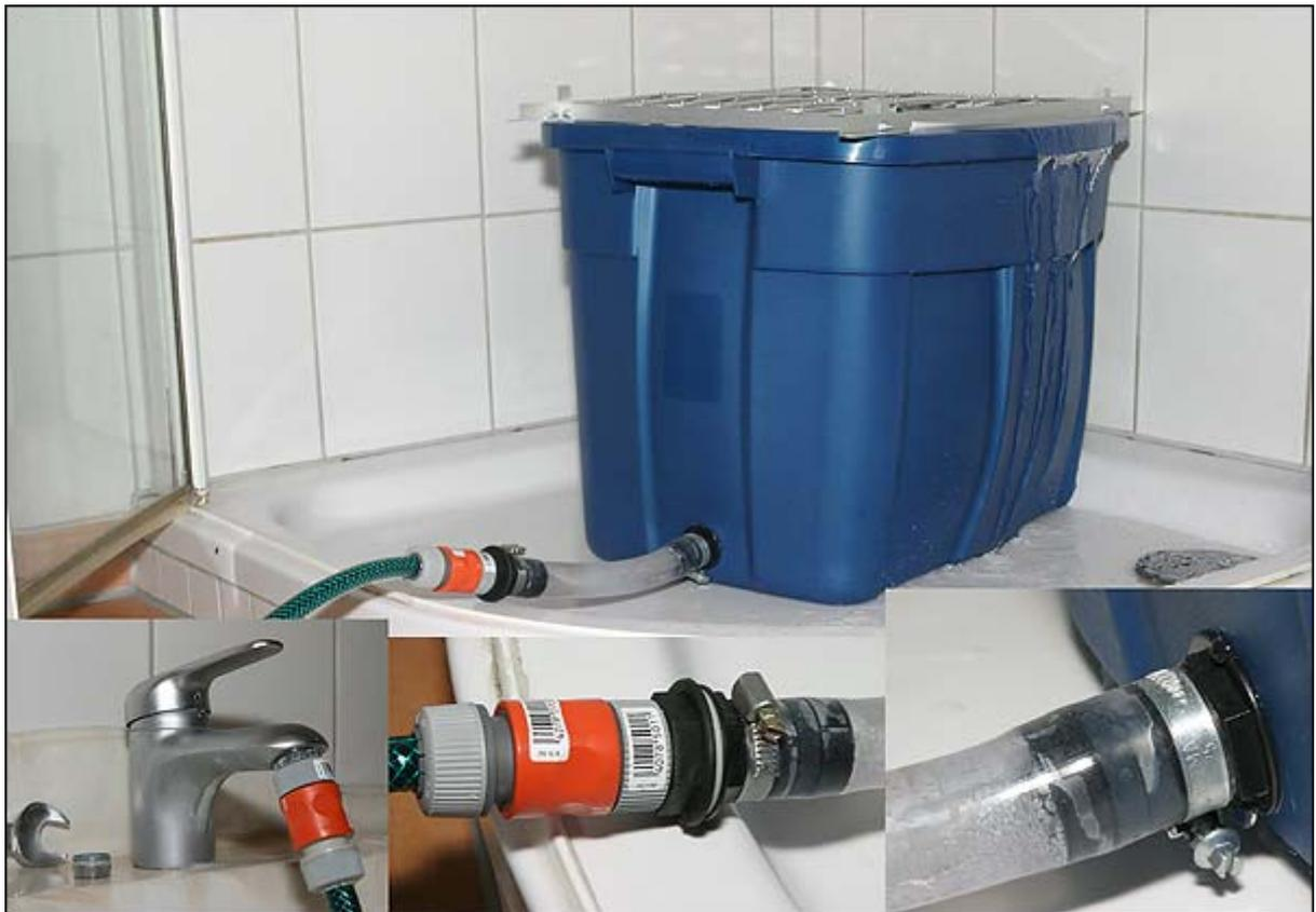
Hier sehen Sie den Barytwascher mit allen außen befindlichen Schlauchanschlüssen, die nur aus standardisierten Schraub- und Steckverbindungen bestehen. Bitte beachten Sie dabei die Schlauchklemmen, auf deren Bedeutung in der Beschreibung gesondert eingegangen wurde.
