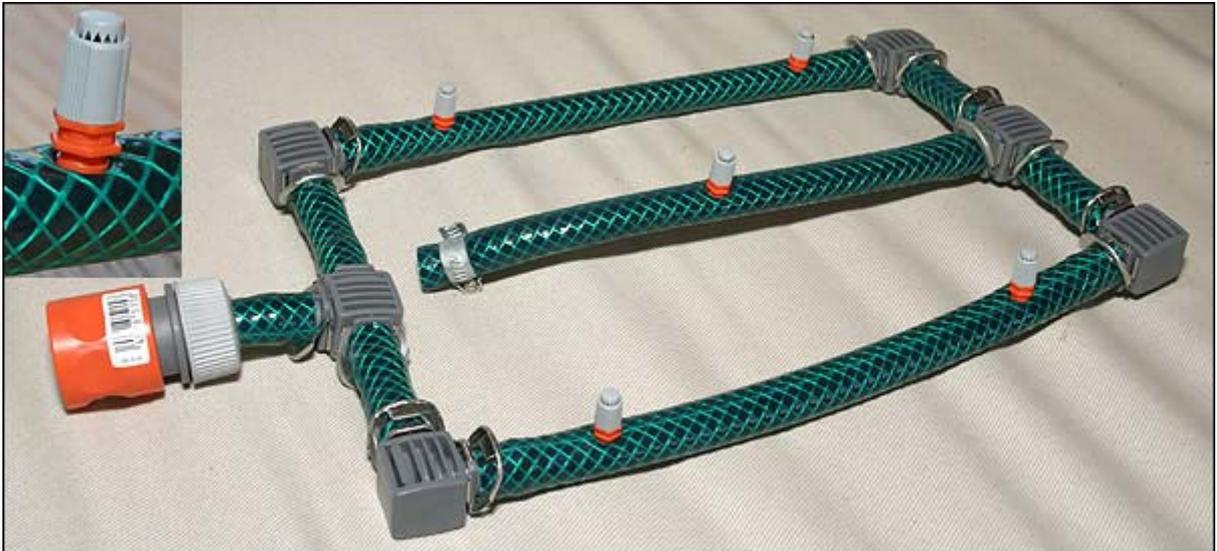
Hier erkennen Sie die einzelnen Schlauchstücke, die mit Hilfe der Micro-Drip-Kupplungsstücke einfach zusammengesteckt wurden: 4 L-Kupplungsstücke und 2 T-Kupplungsstücke sind dazu erforderlich. Ebenso können Sie hier im Detail eine der 360°-Sprühdüsen erkennen, die einfach in den Schlauch eingeschraubt werden. Selbstverständlich können Sie auch weitere Sprühdüsen ganz nach Bedarf einschrauben.
