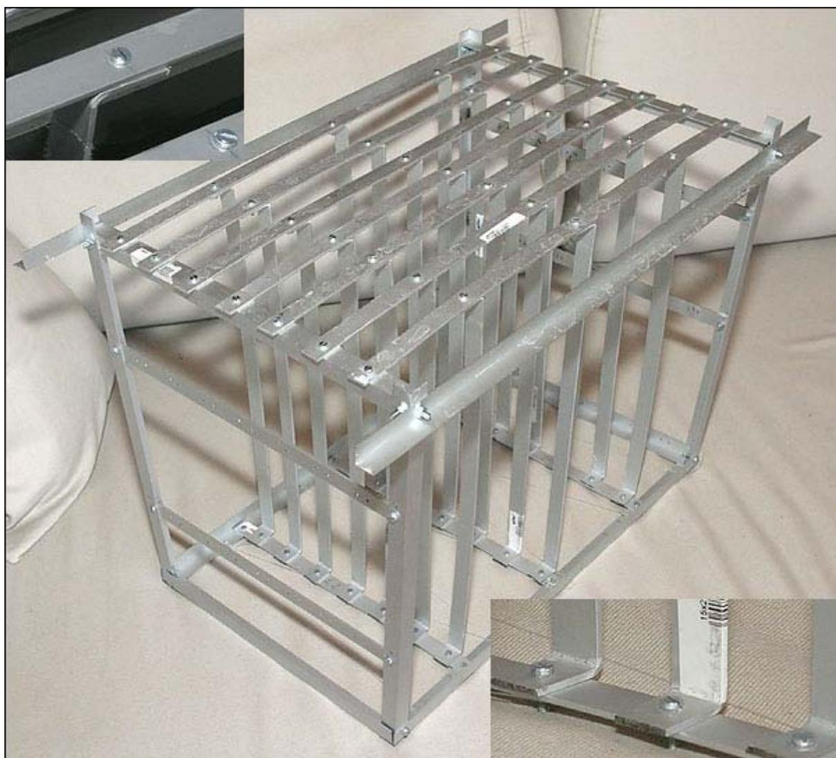
Oben erkennen Sie die einfache, aber extrem stabile Schraubkonstruktion des Wässerungskorbs. Die Leisten aus Aluminium lassen sich, wie auf den Detailaufnahmen zu sehen ist, einfach umbiegen und so an jede benötigte Größe anpassen.
