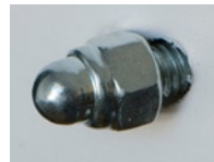
Abb. 2: Die Hutmutter links verwende ich unten an der Hohlkehleplatte vorne, die Rändelmutter am oberen Ende der Gewindestangen.
