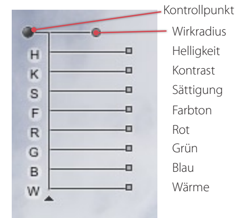
Abb. 2: Die Funktion der Regler des Kontrollpunktes. Der Kontrollpunkt ist hier in der Grundstellung.
